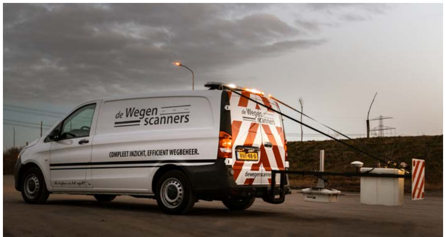
De Wegenscanners hebben een sensor bedacht die de waarden van het steenslag in asfaltbeton kan meten.
