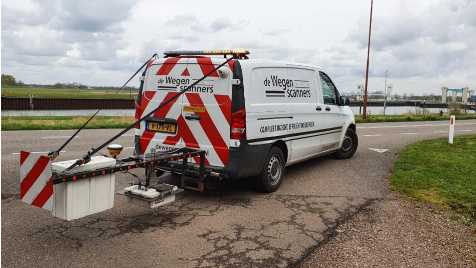
Figuur 1 Meetopstelling van het rijdende meetsysteem met de gammaspectrometer (in de bus) en de grondradar.
